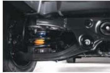
Çok noktadan bağlantılı arka süspansiyon Gelişmiş mekanik sayesinde sürüş konforu sağlar.
